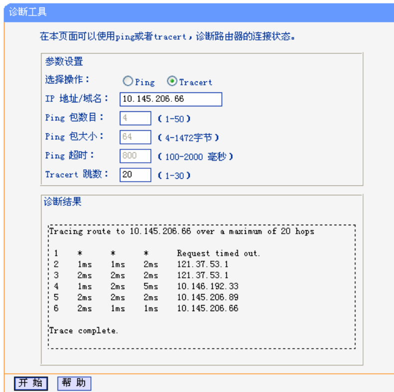
图 5-58 Tracert 诊断结果—成功
