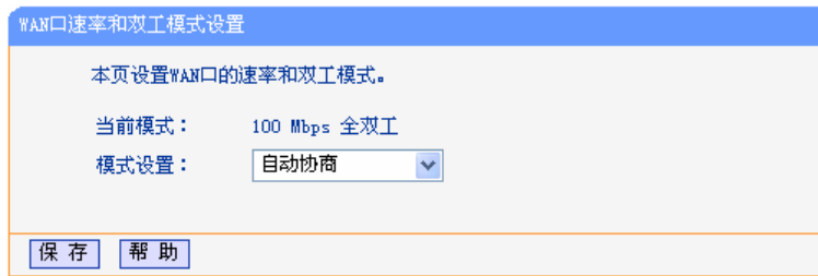
图 5-8 WAN 口速率和双工模式设置
